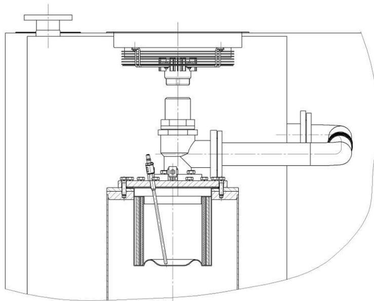
**ВНИМАНИЕ:** ПРИ СНЯТИИ КРЫШКИ НЕ ПОВРЕДИТЕ ТРУБКУ ОТВОДА МАСЛА ИЗ КАРТРИДЖА (УСТАНОВЛЕНА НА ВНУТРЕННЕЙ СТОРОНЕ КРЫШКИ).
