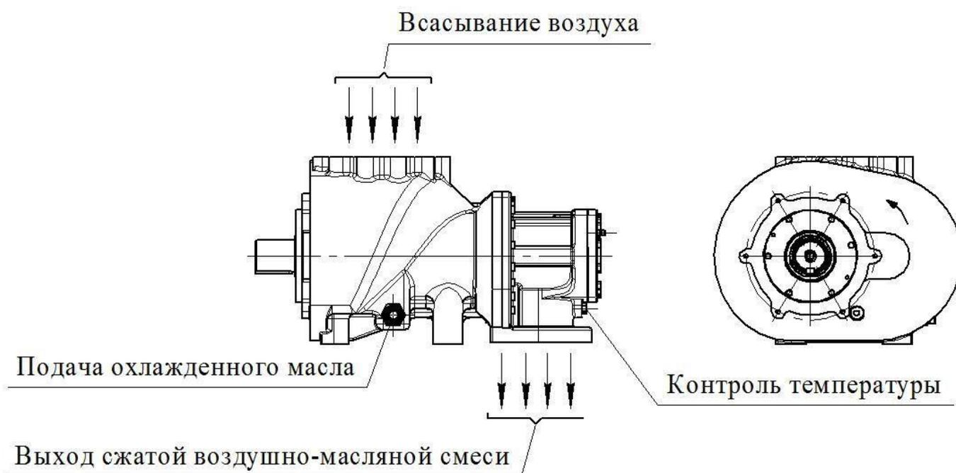
**ВНИМАНИЕ: НАПРАВЛЕНИЕ ВРАЩЕНИЯ ВАЛА ВИНТОВОЙ ГРУППЫ УКАЗЫВАЕТ СТРЕЛКА, РАСПОЛОЖЕННАЯ НА ВИНТОВОМ БЛОКЕ СО СТОРОНЫ ТОРЦА ВАЛА.**
